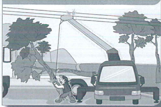
크레인 작업시 전력설비 접촉 주의
